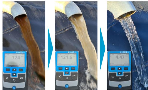
Überprüfungen der Trübungswerte geben deutlichen Aufschluss über den Fortschritt und Erfolg der Reinigung.
