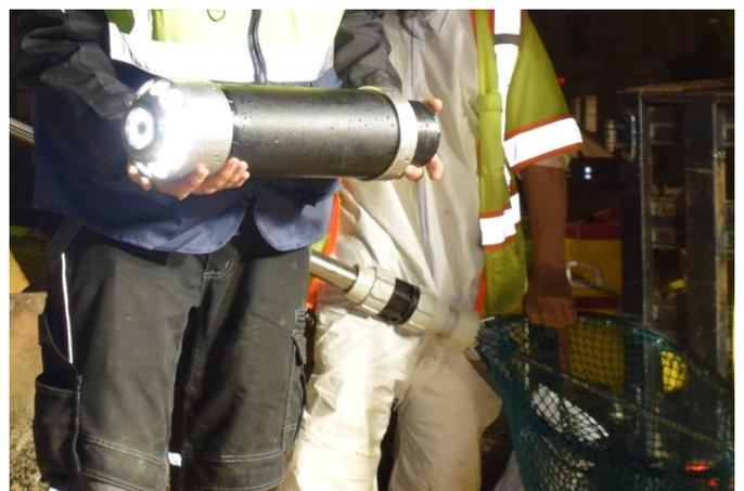
MTA Pipe-Inspector DN125, bereit für die Datenübertragung
